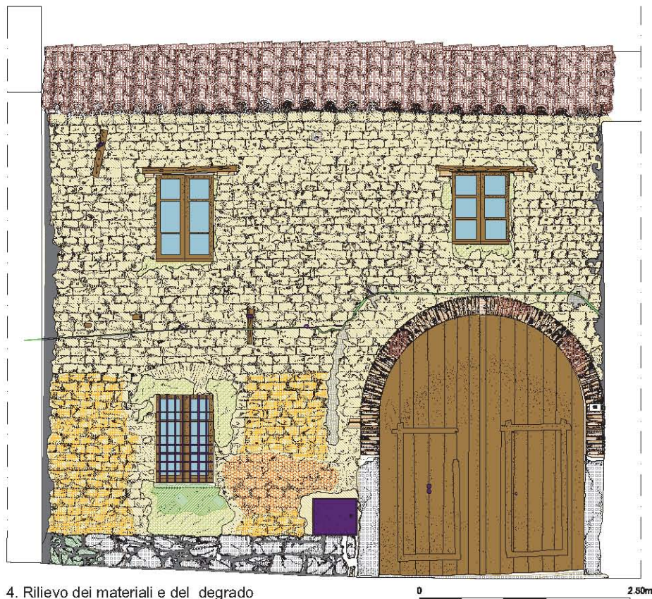
4. Rilievo dei materiali e del degrado
